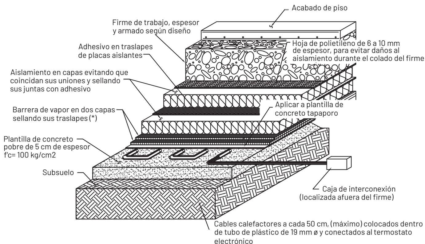
(\*) Únicamente se aplican dos capas de barrera de vapor y la malla de refuerzo poliéster en las barreras de vapor asfálticas, en las barreras de vapor autoadheribles solamente se necesita una capa y no se requiere la malla de refuerzo poliéster.
