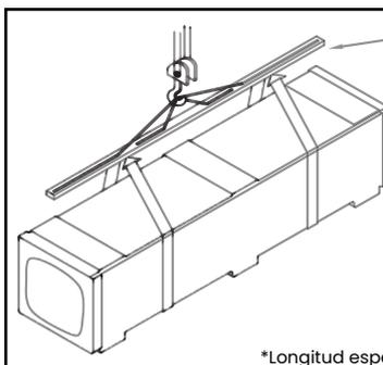
Balancín de 6m para repartir uniformemente el peso del paquete al momento de levantarlo.
