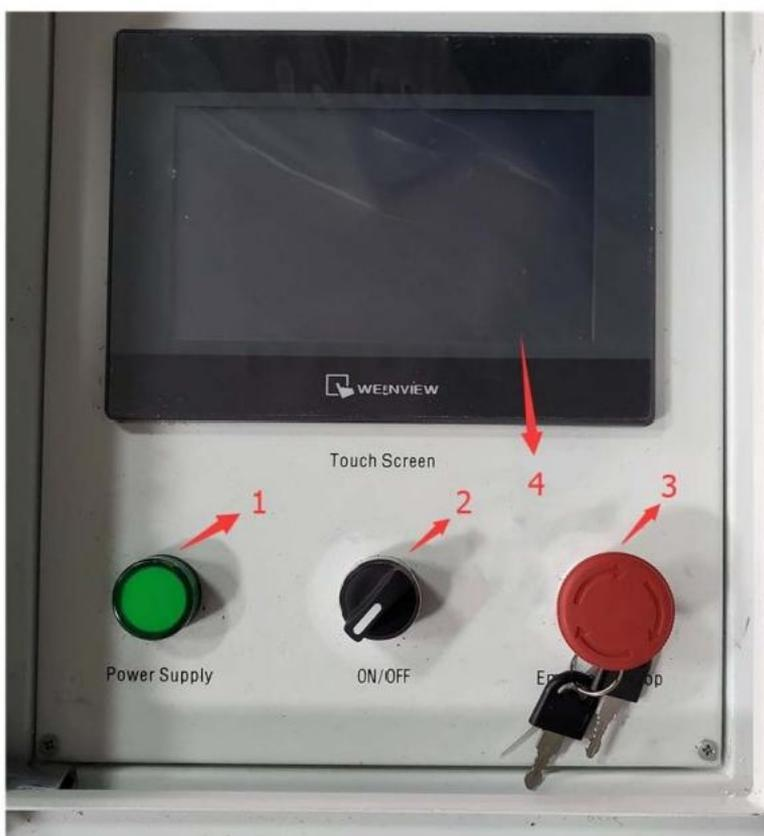
Figura 4.2 Panel de caja eléctrica pequeña dividida Figura 4.2 Dividir el panel de caja pequeña
