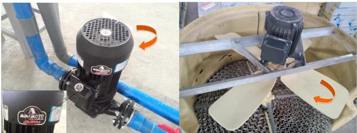
**Gráfico 18 Direcciones para Bomba de agua enfriada y motor de ventilador enfriado**
