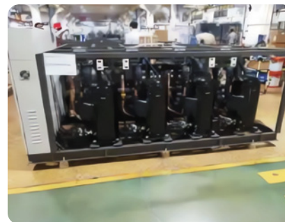
Unidad condensadora armada con doble línea de succión.
