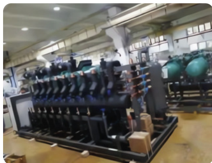
Rack de compresores rotativos de tornillo de doble línea de succión.
