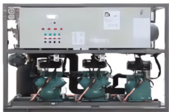
Rack de Compresores Semi-herméticos de Pistones. Potencia: 54, 59, 64, 69, 74, 79, 84, 90, 96, 102 HP MT/LT -40 ~ -5°C
