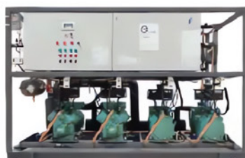
Rack de Compresores Semi-herméticos de Pistones. Potencia: 112 HP MT/LT -40 ~ -5°C
