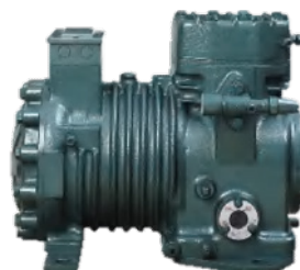
Compresor Semi-hermético de Pistones. Potencia: 6, 7.5 HP Temp. de Vaporización: -45 ~ -5°C
