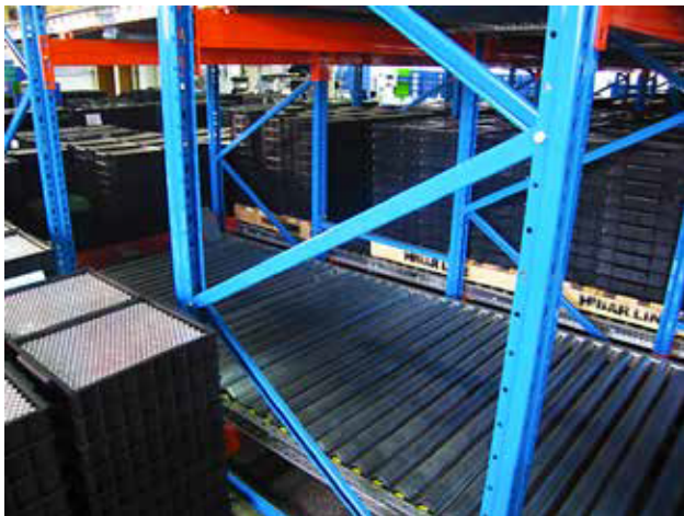
Sistema de rodamiento por gravedad
